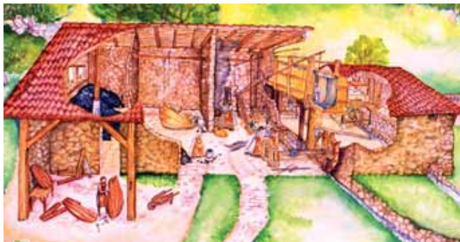
Urkuluko burdinolaren balizko irudia: Hau Aretxabalaga erreken parean egindako azken burdinola izan zan, eta Uriak berak eraiki eban. Alokairuan ipini zan eta dituturria izan zan uriaentzat. Burdinola honek antapara bi ebazan. Goikoak, ur-jauzi handia ebanak, mailu nagusia mugiten eban; eta besteak, hauspoa. Baina goikoak sobran eukanak behekoa elikatze balio eban; eta jakina, behekoak errotea be mugiten eban. Mendeetan zehar Iruzubieta deitu deusie (inguruko azpiegituran egozan hiru zubiakaitik. Irudia: Sara Estevez.
